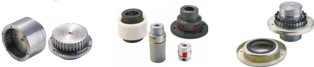
Die AXO-Zahnkupplungen liegen im Drehmomentbereich von 358 bis 6430 Nm und haben ballige Zähne zur Aufnahme von axialem Versatz sowie eine mögliche Bohrung von 20-125 mm.
