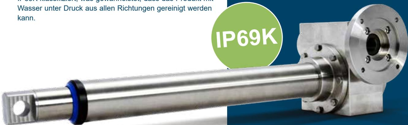
Die Schutzart des Stellantriebs aus Edelstahl ist IP69K was gewährleistet, dass das Produkt mit Wasser unter Druck aus allen Richtungen gereinigt werden kann. Um genauer zu sein wird der Stellantrieb mit Wasser aus den Winkeln Winkeln von 0°, 30°, 60° und 90° in einem Abstand von 30 Sekunden in jeder Position und in einem Abstand von 10-15 cm zu besprühen.
